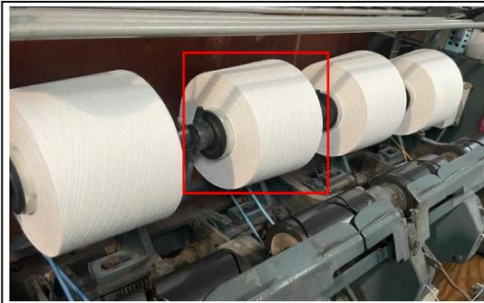
チーズ染色において、原糸を染色用に巻き上げる工程は原糸に染色液を均一に行き渡らせるため染色品質に大きく影響する。これまでの同社では巻き上げ工程は外注を活用していたが、後継者不在の外注先を事業承継することで作業品質の維持、地域雇用の維持を両立させていく方針である。
