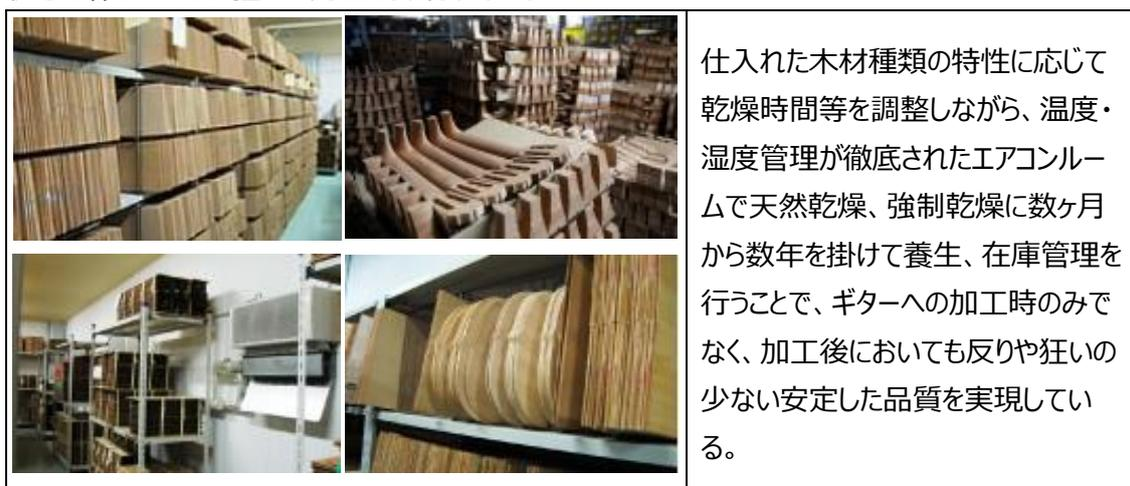
これらの取り組みによって、限りある資源の天然木材を主原料とするギター製造において同社では原材料の保管・管理を徹底することにより材料のロス削減に努めている。さらに、材の貼り合わせ等の技術向上に努めることで木材が不足するなかでも品質を維持したギターづくりを実現している。
